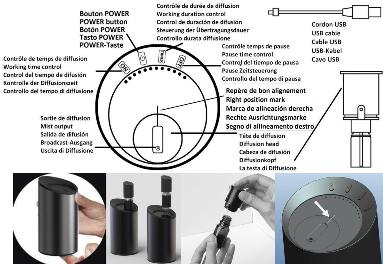
**Etape 1 :** L'installation ou le remplacement du flacon nécessite d'éjecter la tête de diffusion de son logement. Pour cela, veuillez exercer une pression sur le bouton situé sous l'appareil.
